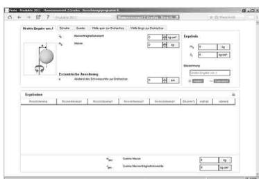
Ya no son necesarios bolígrafos y calculadoras manuales. Ya se trate de discos, paralelepípedos, bridas de conexión, pinzas, etc., el software calcula todos los momentos de inercia de las masas. Guardar, aplicar o imprimir y ¡listo! Esta herramienta está disponible
