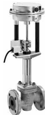
Válvula de paso recto para aceite térmico Tipo 3531-P, con accionamiento neumático y final de carrera eléctrico Tipo 4744-2
